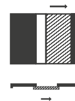
2 ante fisse con 1 anta centrale apribile 2 fixed sashes with 1 central sliding sash
